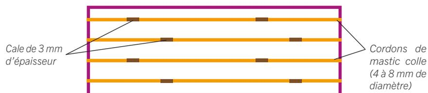
**3** **Lame d'air d'équilibrage** Aménagement d'une lame d'air de 4 mm au dos des panneaux en positionnant des cordons de colle verticaux (ø 6 à 8 mm) sur toute la hauteur du stratifié et directement sur le stratifié :
