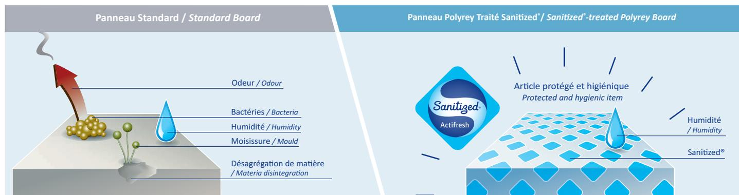
Incorporé dans le matériau pour garantir une protection antibactérienne tout au long de sa durée de vie, cet additif biocide n'influence pas les performances techniques et esthétiques de nos panneaux.
