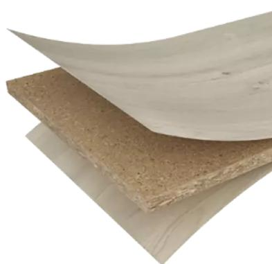
**Panoprey®** est une gamme de panneau mélaminé prêt à l'emploi. Fabriqués en France, les panneaux mélaminés Panoprey® résultent de l'application directe d'une feuille de papier décoratif imprégnées de résine mélamine sur chaque face du panneau support ; à chaud, sous pression et sans l'utilisation de colle.
